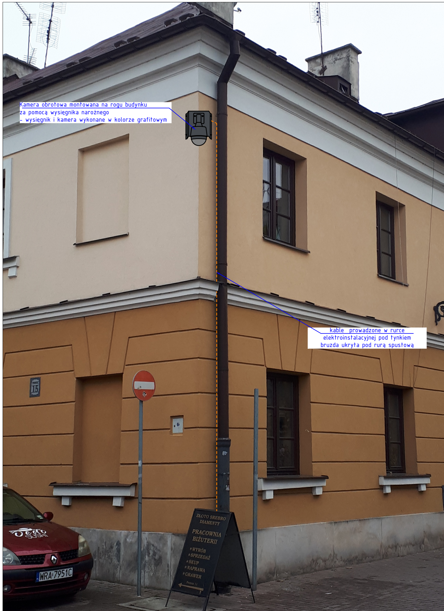
Wizualizacja planowanej zabudowy kamery obrotowej na rogu budynku przy ul. Pereca 15/Bazylińska 7
